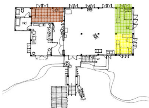
รูปที่ 2.14 รูปตัด ผังพื้น และการกันห้องชั่วคราวภายในเรือนทรงบังกะโล อ.เสนา จ.พระนครศรีอยุธยา
